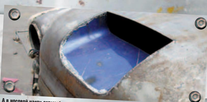
А в носовой части автомобиля, в багажнике (сложно привыкнуть – тут все наоборот: багажник спереди, а капот – сзади) было вырезано отверстие, и приварена металлическая ноздря. Получилось весьма агрессивно.
