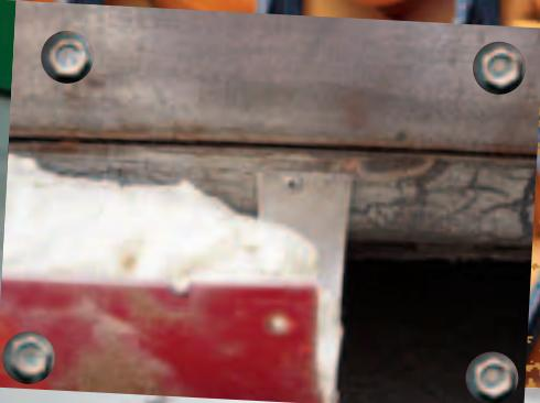
Обвес был порезан в соответствии с нуждами Горбатого, и укреплен на заклепки...
