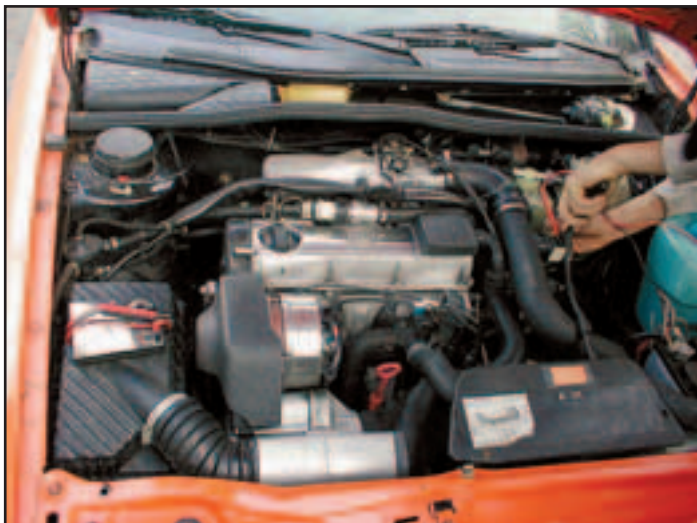
➤ Это - мотор PG с нагнетателем G60 - серебристая фиговина внизу на фото и есть этот самый нагнетатель.
