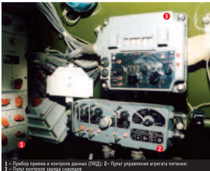
1 - Прибор приема и контроля данных (ПКД); 2 - Пульт управления агрегата питания; 3 - Пульт контроля заряда снарядов
